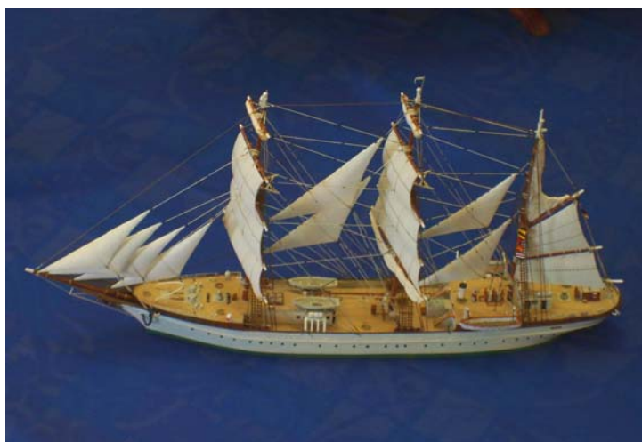
Bajai Árpád miniatűr vitorlása, a „GORCH FOCK”. A hajótest és az árbocozat műanyag kit, a vitorlázat és a kötélzet viszont teljesen egyedi készítésű (a kötélzet angyaga húzott szál).
