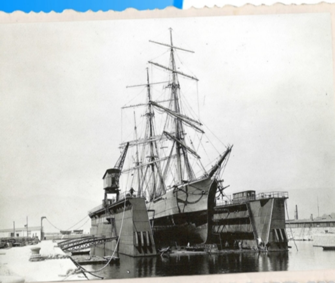
Acél vitorlás bark a Howaldt gyár fiumei úszódokkjában Sailing ship made from steel is in the Howaldt floating dock in Fiume
