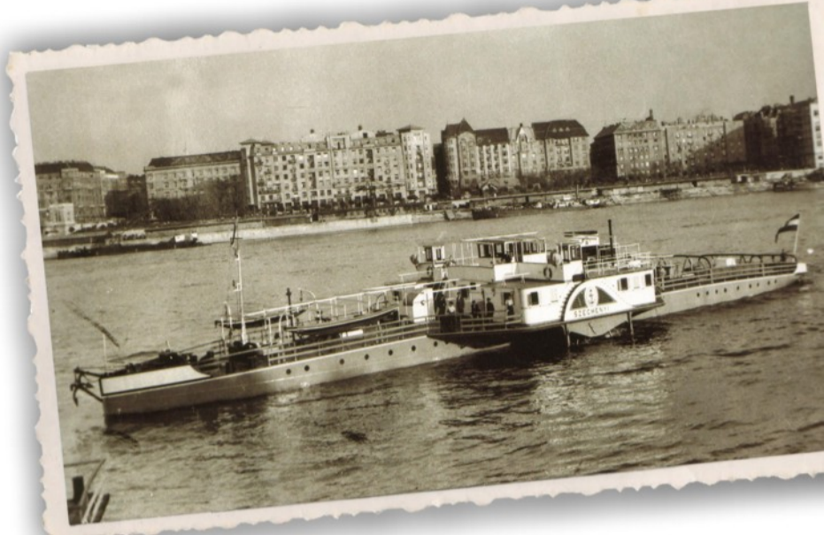
A SZÉCHENYI, Európa első diesel-elektromos vontatója The SZÉCHENYI first diesel-electric side-wheeler tug of Europe
