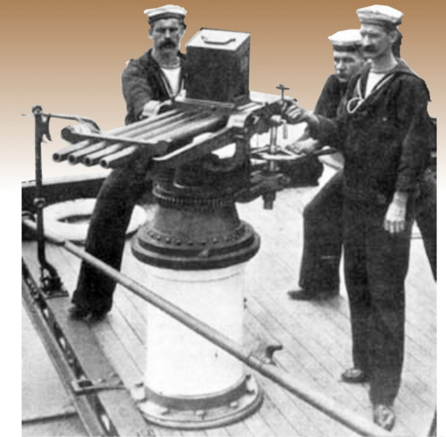
Az 1878-ban beépített 2 db 25,4 mm-es Nordenfeld-szórólöveg egyike. A közös tulajdonú hajókon vegyes nemzetiségű legénység dolgozott, az egyre növekvő számarányú magyar (50%) mellett elsősorban horvát, délszláv; s csak kismértékben osztrák. Amennyire a tengeri flottánál dominált az osztrák részvétel, annyira jelentős volt a Duna-flottillánál a magyar.
