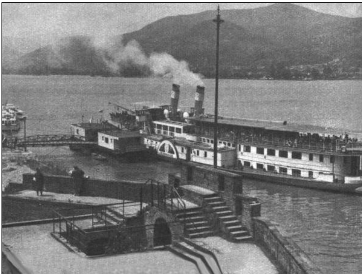
A visegrádi hajóállomáson az 1958-as felújítás után. Új szerkezeti elem a kémények két oldalán kialakított zárt folyosó.
