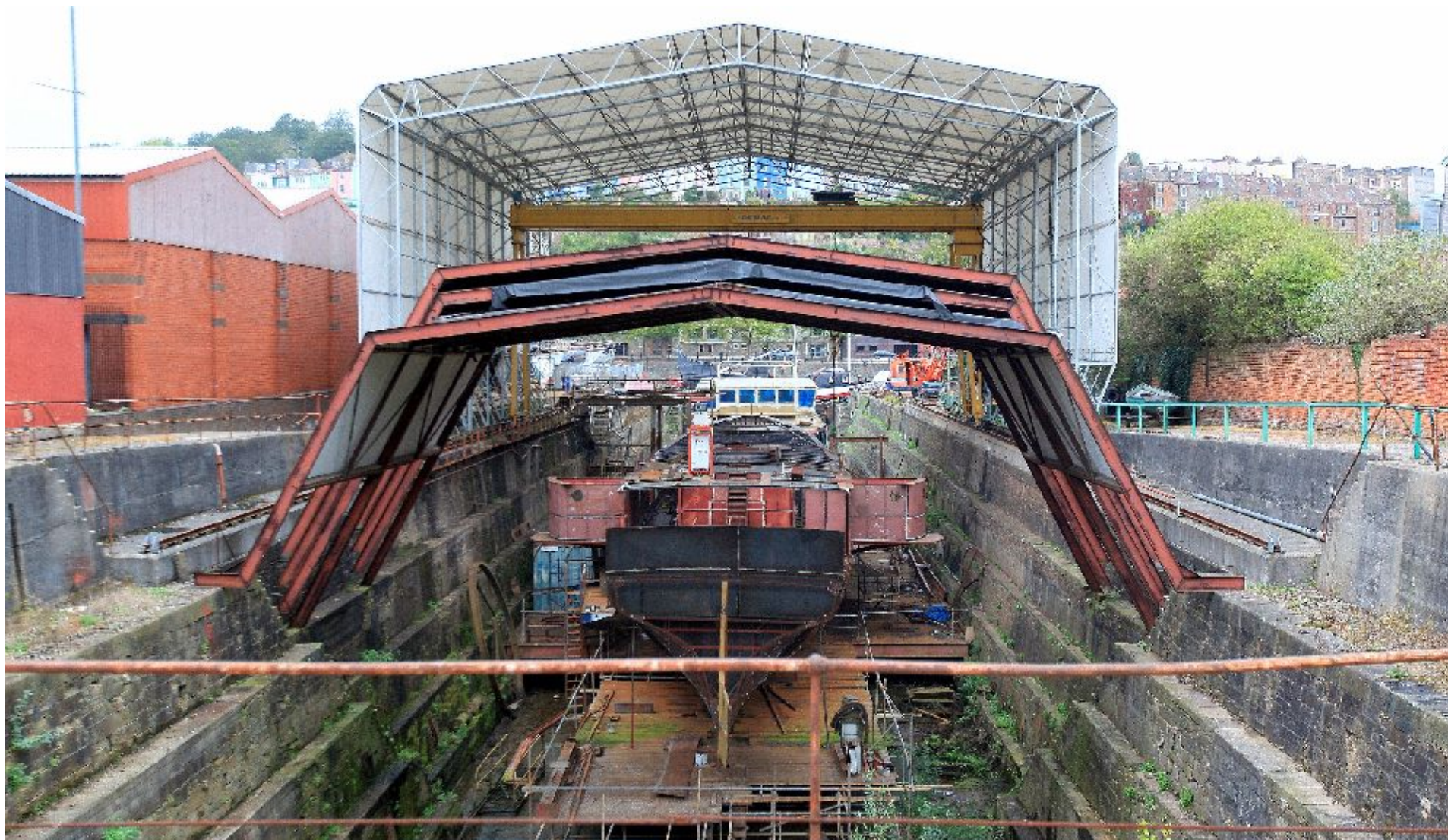
9. ábra: a MEEDWAY QUEEN épülő új szegecselt hajóteste a tat felől és a kész lapátkerékdobok
