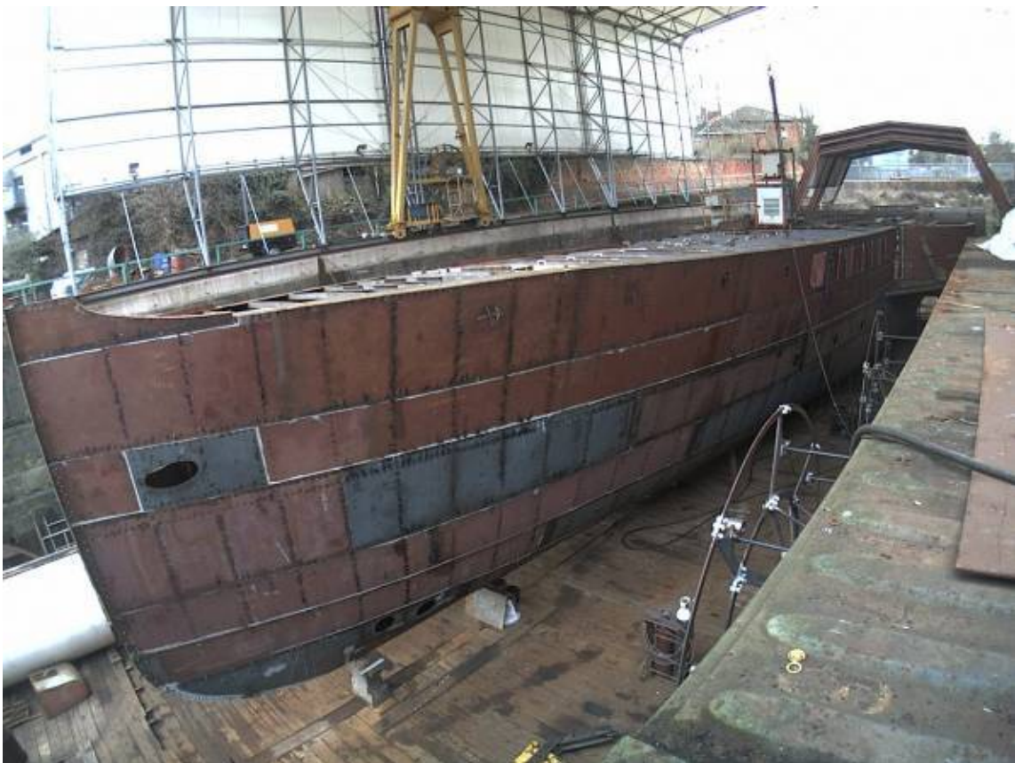
8. ábra: a MEEDWAY QUEEN új szegecselt hajótestének elkészült orr-része
