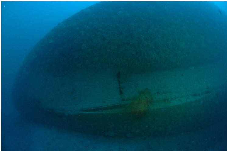
A nagy horpadás eleje a hajóorr bal oldalán (Danijel Frka felvétele).
