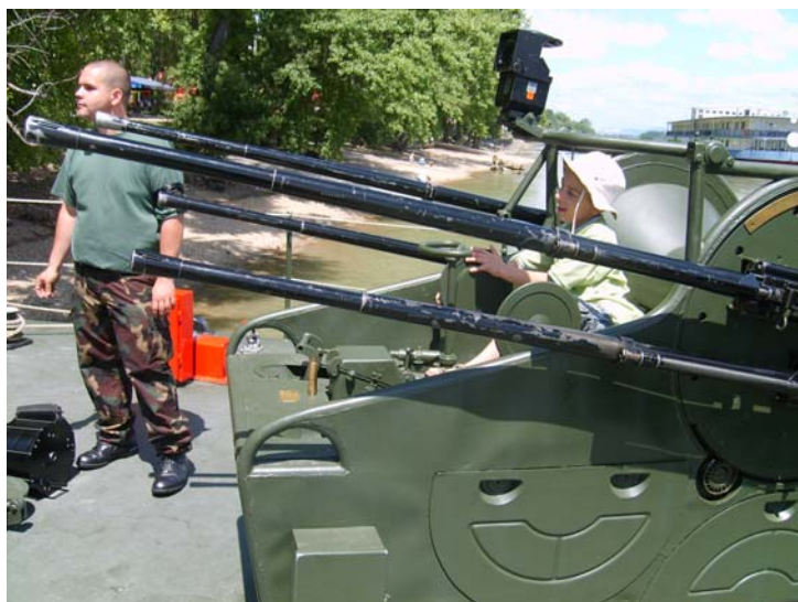
Az aknamentesítő naszádj fő tüzérsége, a 4 db 20 mm-es gépágyú. A tat-fedélzeten felállított egycsővű változattal ellentétben ennek a fegyvernek az irányzása gépi erővel történik.
