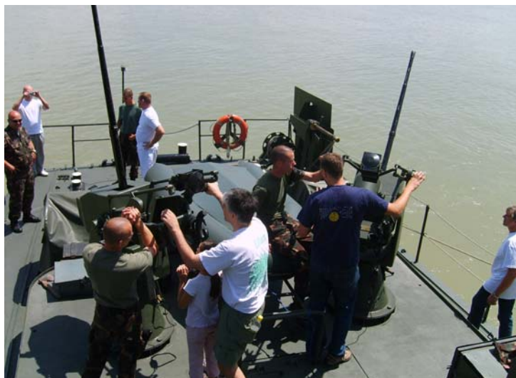
A tat-fedélzeti 20 mm-es gépágyú. Mivel ezeket a fegyvereket a kezelők közvetlenül kézzel irányozzák, irányításuk valamivel nehezebb az orr-fedélzeti ágyúkéhoz képest.
