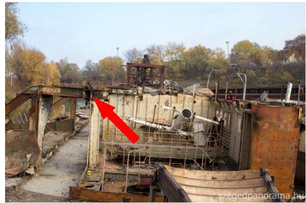
3. ábra: A megszűnt funkciójú, átvágott fő kereszt-tartók a felépítmény nélküli hajótesten 2012. november 16-án.
