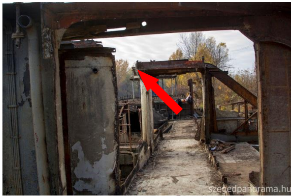
3. ábra: A megszűnt funkciójú, átvágott fő kereszt-tartók a felépítmény nélküli hajótesten 2012. november 16-án.
